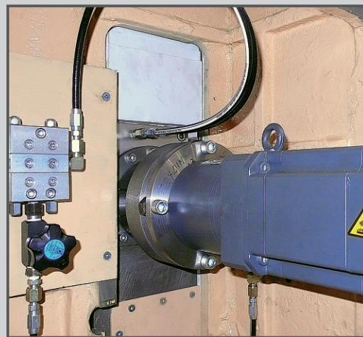
Система ЧПУ, построенная на базе программируемого контроллера Simatic S7-300 с модулем позиционирования FM357-2L фирмы SIEMENS, управляет по заданной программе тремя осями движения (люлькой, шпинделем изделия и приводом подач стола) и двигателем главного привода.
